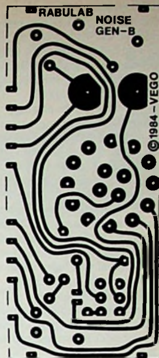
Afb. 9 Printontwerp van de bedieningsprint, schaal 1 : 1.
